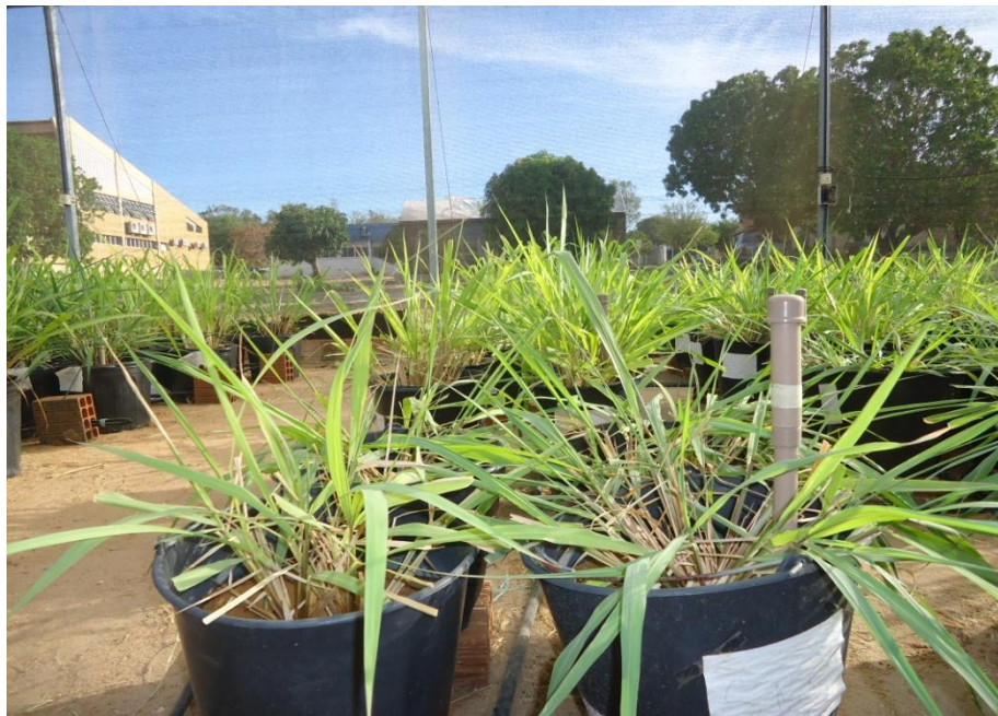
Figura 5. Detalhe da instalação dos tensiômetros nos vasos.
