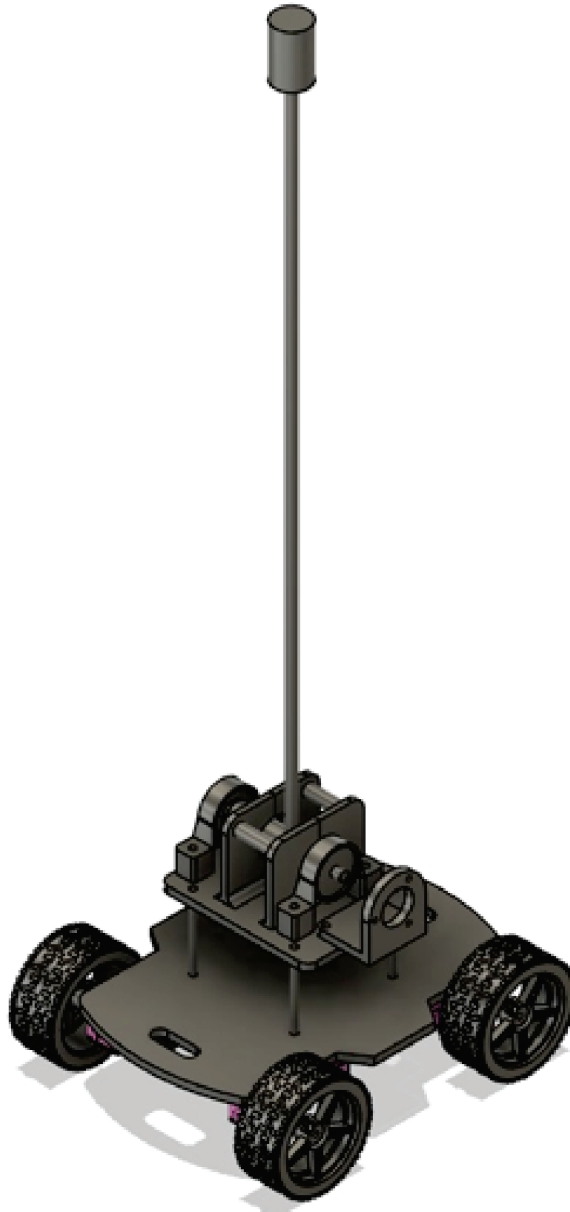
Figura 4: Montagem das partes do pêndulo invertido.
