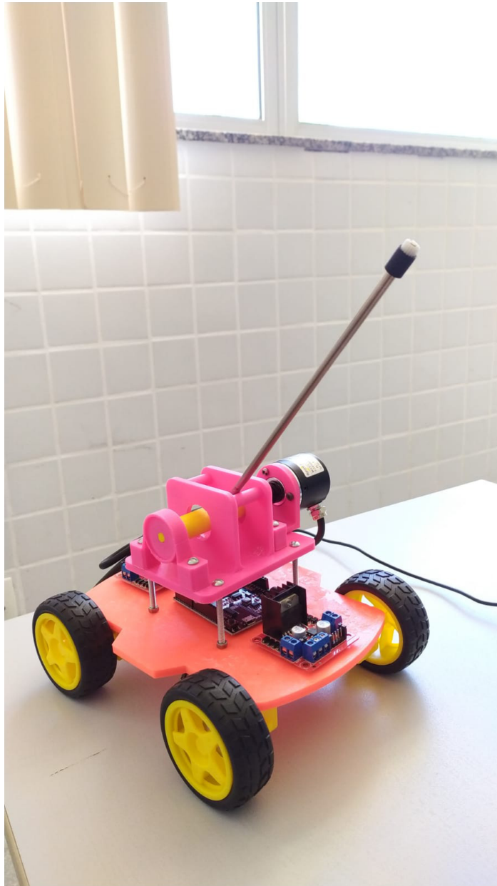
Figura 11: Protótipo de pêndulo invertido desenvolvido.
