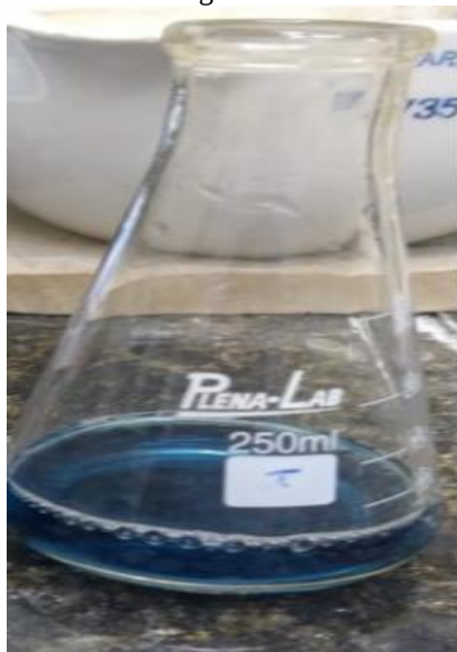
Figura 30 - Solução com indicador Negro de Eriocromo T titulada com EDTA.
