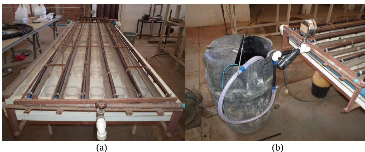
Figura 5. Bancada de teste: a) detalhe das mangueiras e recipientes b) reservatório e cabeçal de controle da bancada
