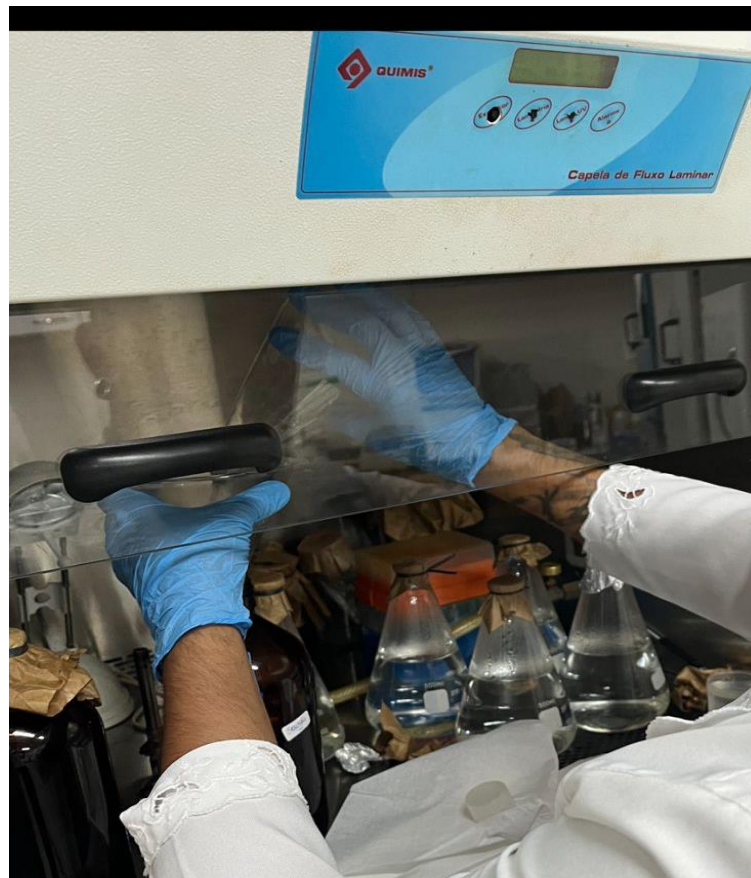
Figura 3 - Processo de transferência da água destilada autoclavada para as garrafas de vidro âmbar
