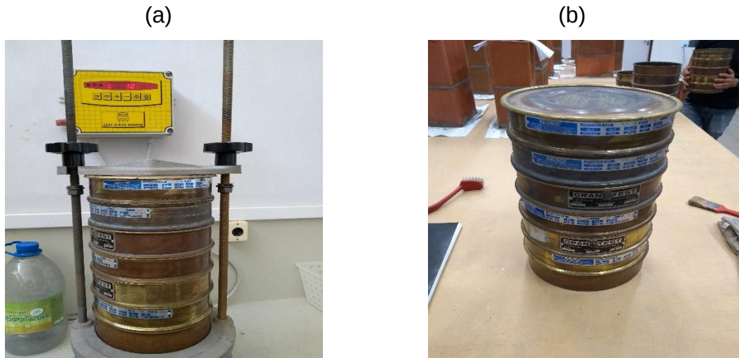
Figura 1: Peneiras utilizadas no ensaio granulométrico e agitador mecânico
