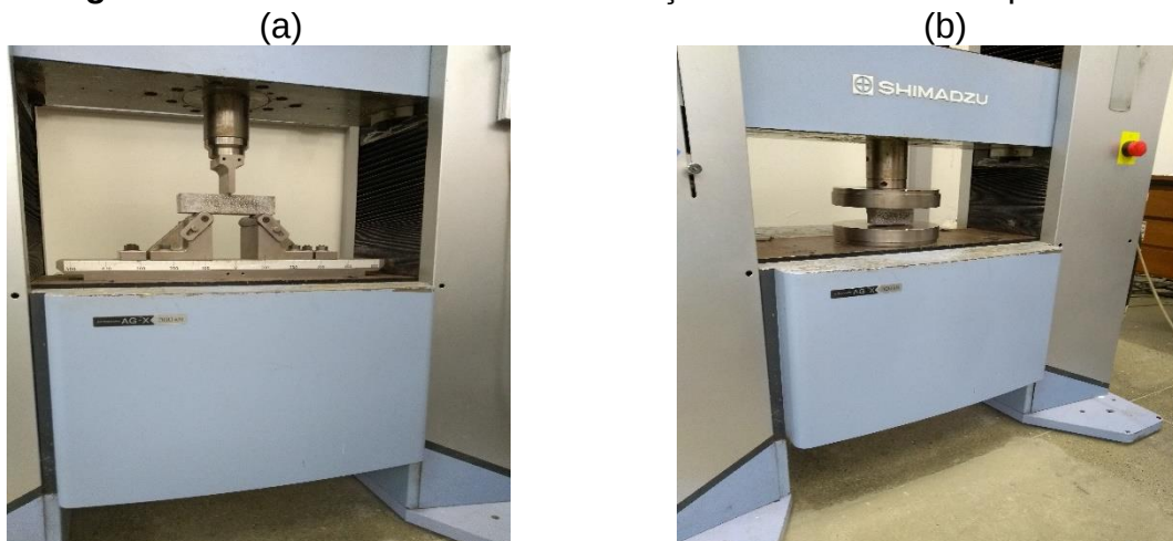
Figura 3: Ensaios de Resistência a tração na flexão e a compressão
