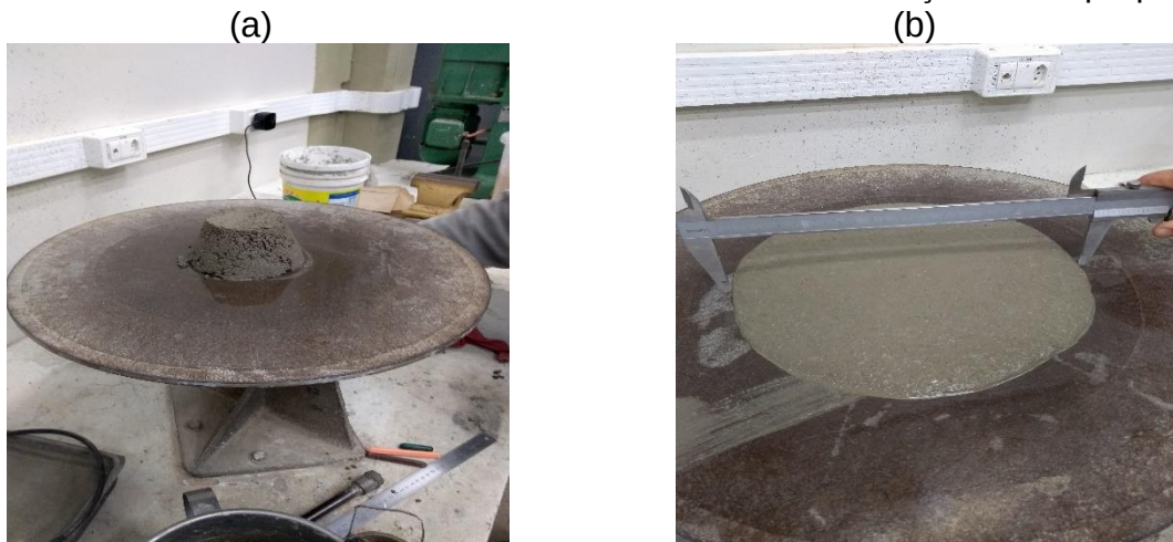
Figura 2: Ensaio de consistência na mesa de abatimento e medição com o paquímetro
