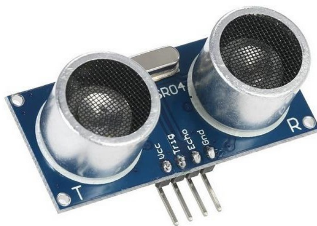
Figura 2 - Sensor ultrassônico – HC-SR04
