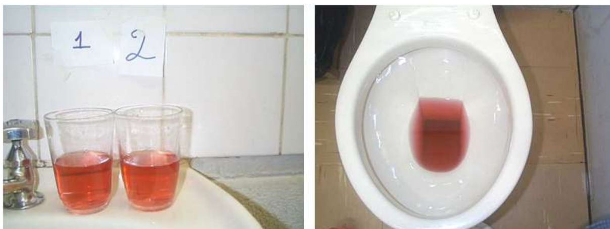
Figura 4: Teste do corante para detecção de vazamentos em bacias sanitárias
