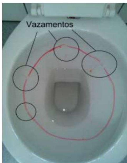
Figura 6: Teste da caneta para detecção de vazamentos em bacias sanitárias
