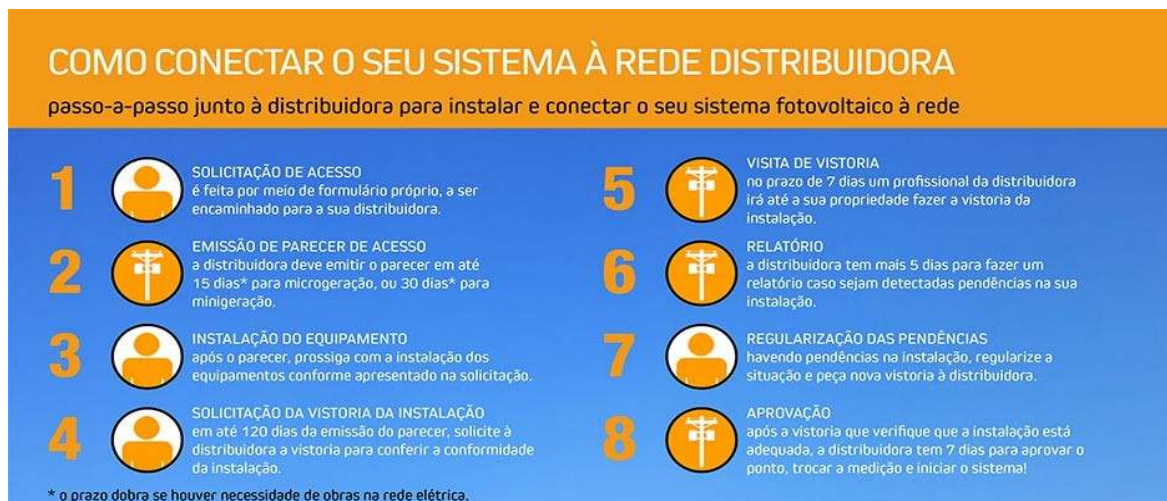
Figura 3 - Conexão do sistema fotovoltaico a rede elétrica pública, [11].
