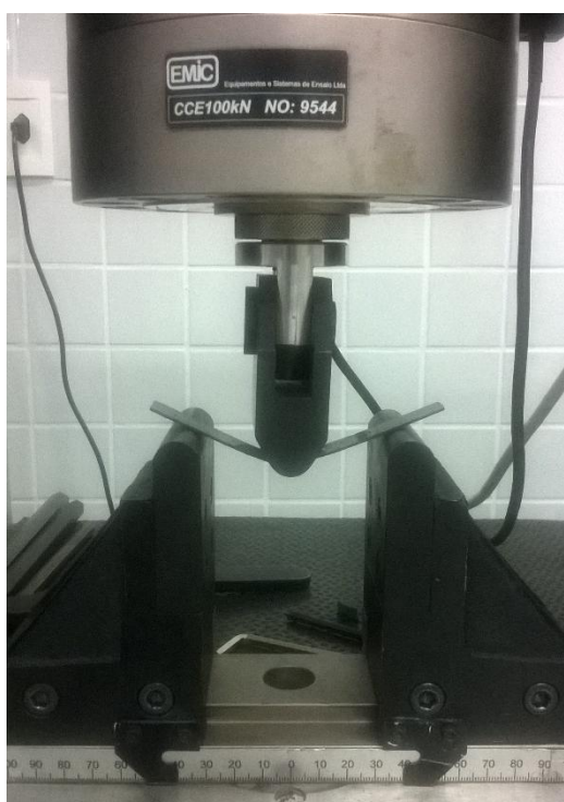
Figura 19 - Ensaio de flexão
