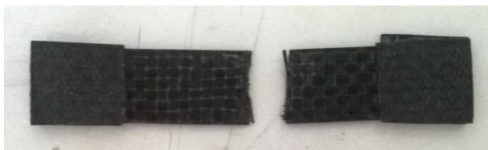
Figura 17 - Corpo de prova fraturado após ensaio de tração
