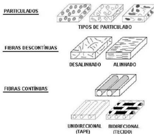
Figura 4 - Esquema da classificação de reforços em compósitos
