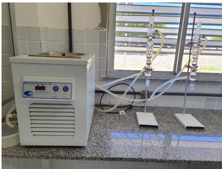
Figura 9 - Sistema adaptado do condensador de refluxo.
