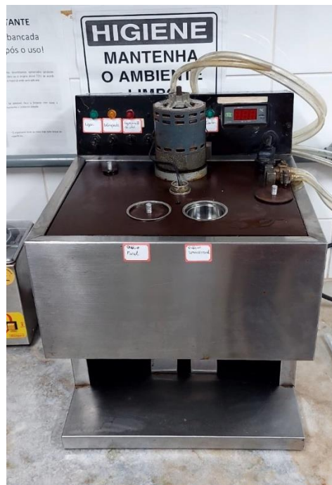
Figura 10 - Viscosímetro Saybolt usado na análise de viscosidade.
