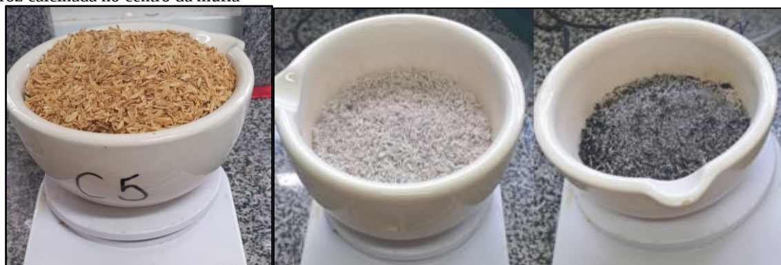
Figura 4: (a) Casca de Arroz antes da calcinação; (b) Casca de Arroz calcinada próxima à superfície; (c) Casca de Arroz calcinada no centro da mufla
