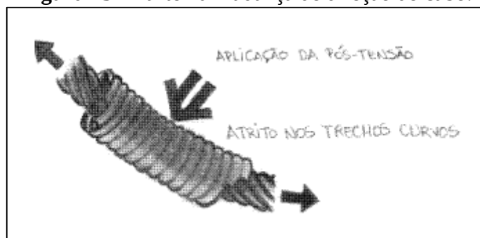
Figura 13 – Atrito na mudança de direção do cabo.
