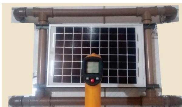
Figura 11. Processo de medição de temperatura dos módulos. (Autoria Própria)
