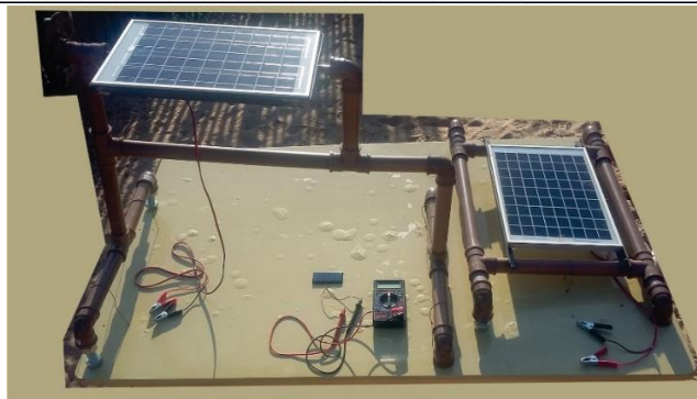
Figura 10. Processo de medição de irradiância. (Autoria Própria)
