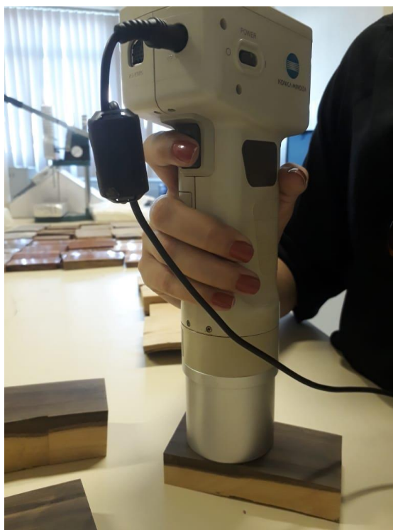
Figura 4. Obtenção do parâmetro Luminosidade pelo equipamento Konica Minolta CR-410, em superfície de madeira de cerne de Auxemma oncocalyx (Pau-branco). Ensaio realizado no Laboratório de Pós-Colheita – Centro de Pesquisas Vegetais do Semi-Árido (UFERSA).
