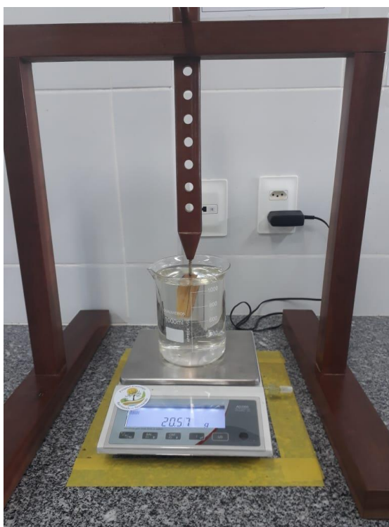
Figura 2. Medição do volume dos corpos de prova de alburno de Auxemma oncocalyx (Pau-branco) pelo método de pesagem por imersão em água, utilizando o Princípio de Arquimedes. Ensaios realizados no Laboratório de Tecnologia da Madeira (UFERSA). FONTE: A autora (2019).
