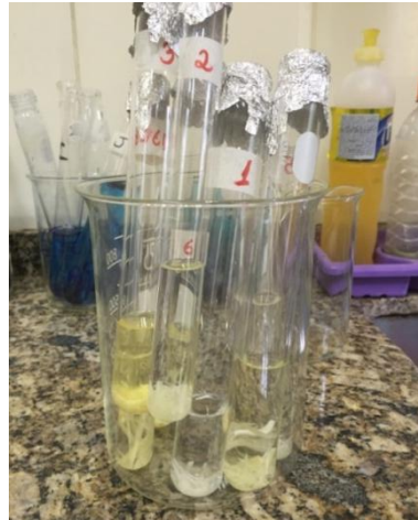
Figura 5. Fragmentos de madeira misturados a uma solução macerante 1:1 de ácido acético glacial e peróxido de hidrogênio ( H_2O_2 ). FONTE: PAULA, 2018.
