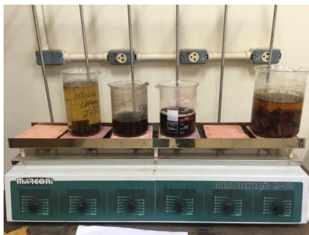
Figura 4. Fervura e preparação dos corpos de prova para a microtomia. FONTE: PAULA, 2018.
