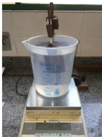
Figura 2. Obtenção do volume saturado usando o método da balança hidrostática. FONTE: PAULA, 2018.
