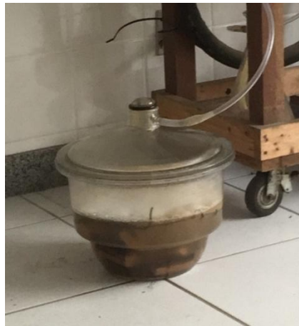
Figura 1. Utilização da pressão a vácuo para atingir o Ponto de Saturação de Fibras (PSF). FONTE: PAULA, 2018.
