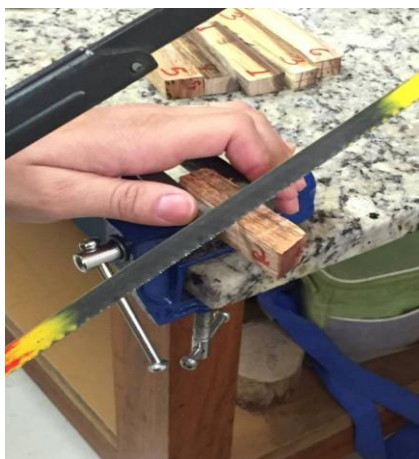
Figura 3. Redução dos corpos de prova para as dimensões 2,0 x 2,0 x 3,0 cm. FONTE: PAULA, 2018.
