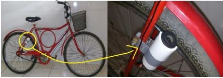
Figura 10: Gerador acoplado a bicicleta.
