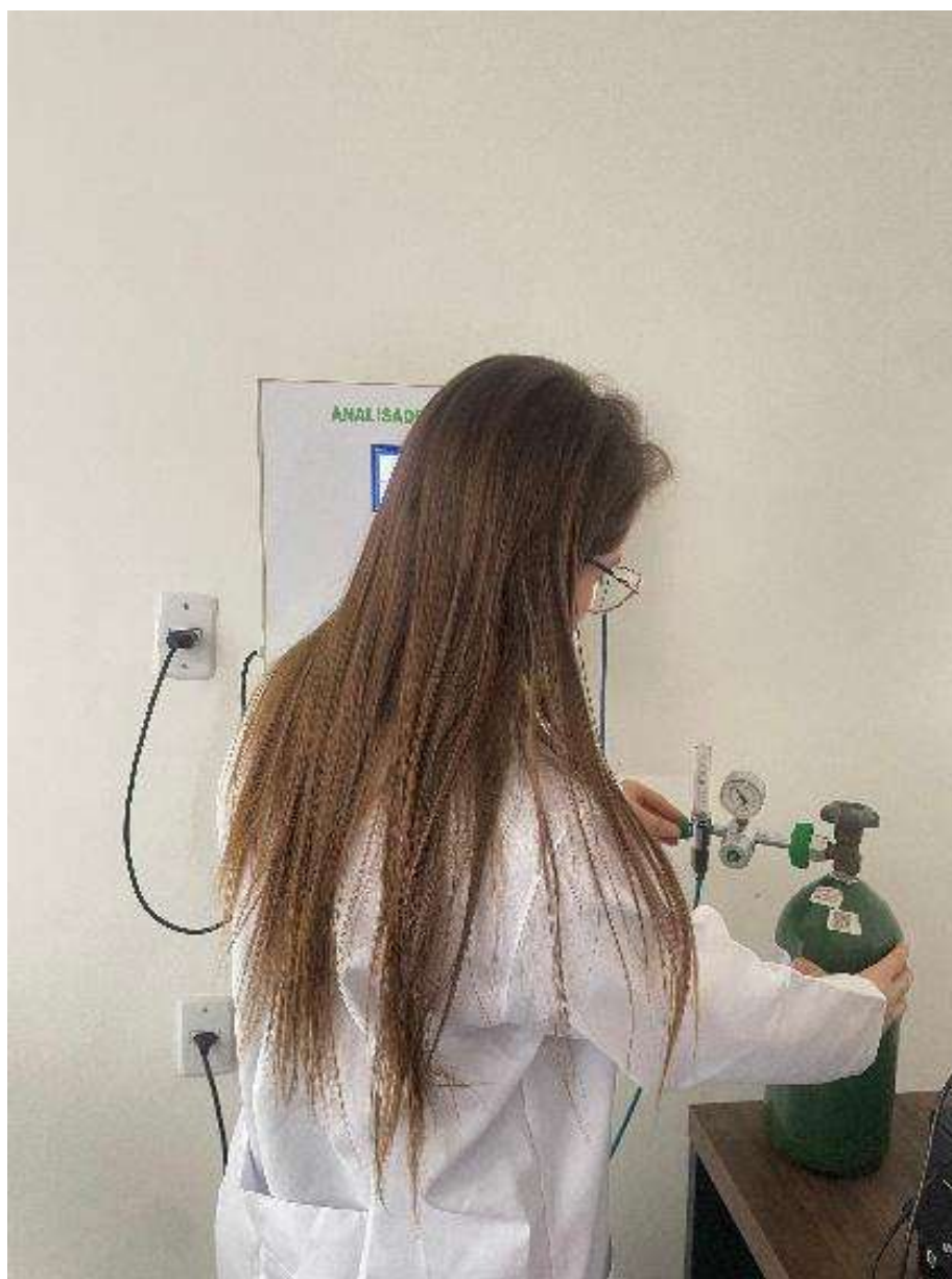
Figura 19: Ajuste do cilindro no analisador paramagnético para avaliar o oxigênio recém envasado
