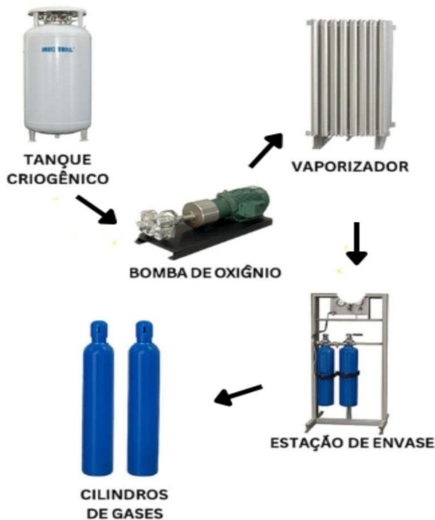
Figura 3: Fluxograma do processo de envase do oxigênio medicinal
