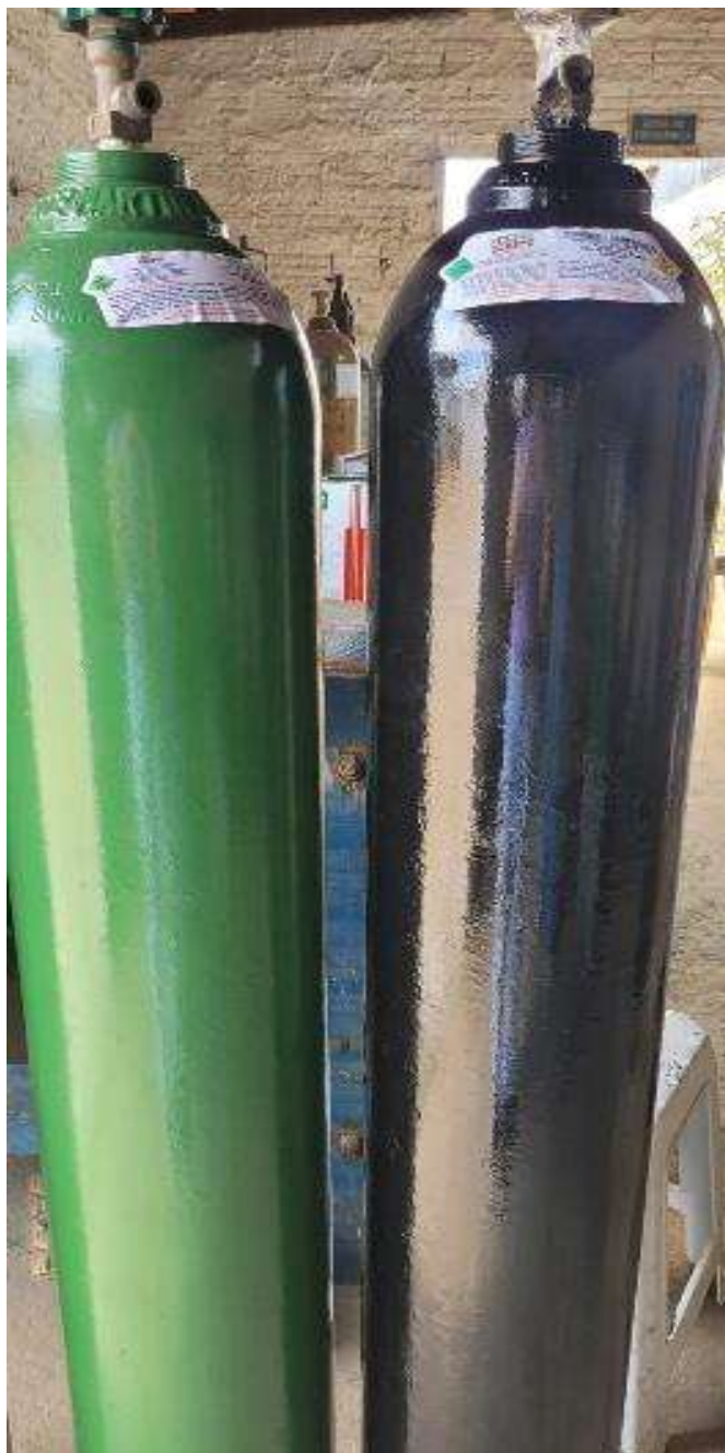
Figura 15: Cilindro secando após manutenção da pintura externa do corpo
