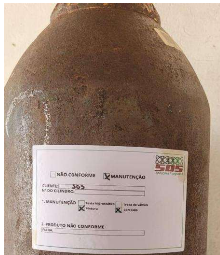
Figura 13: Cilindro etiquetado conforme o problema encontrado
