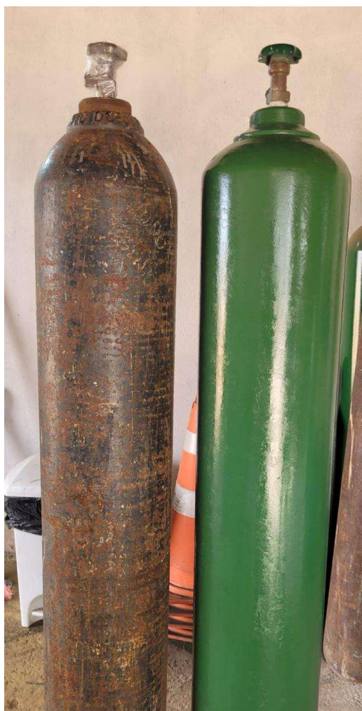
Figura 14: Comparação de um cilindro em manutenção com um cilindro prestes a voltar para circulação
