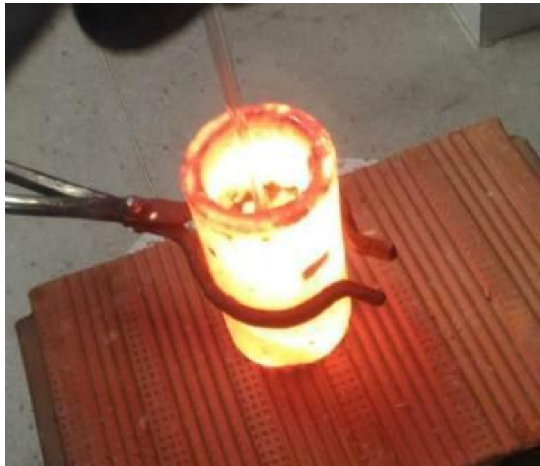
Figura 6 - Processo de fundição tradicional - Cadinho de argila-grafite.
