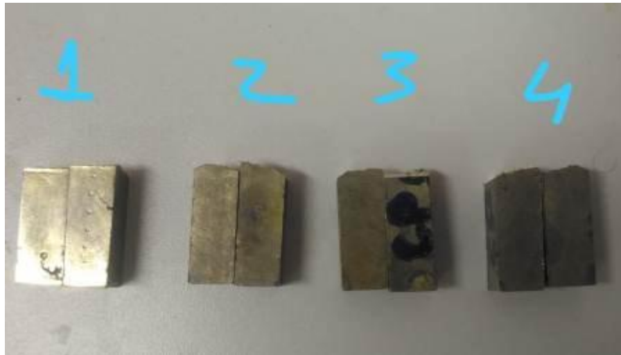
Figura 10-Corpos de prova rompidos apresentando característica de fratura frágil - vista lateral.
