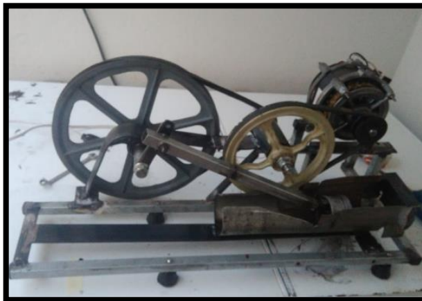
Figura 12: Fase final da construção do compactador
