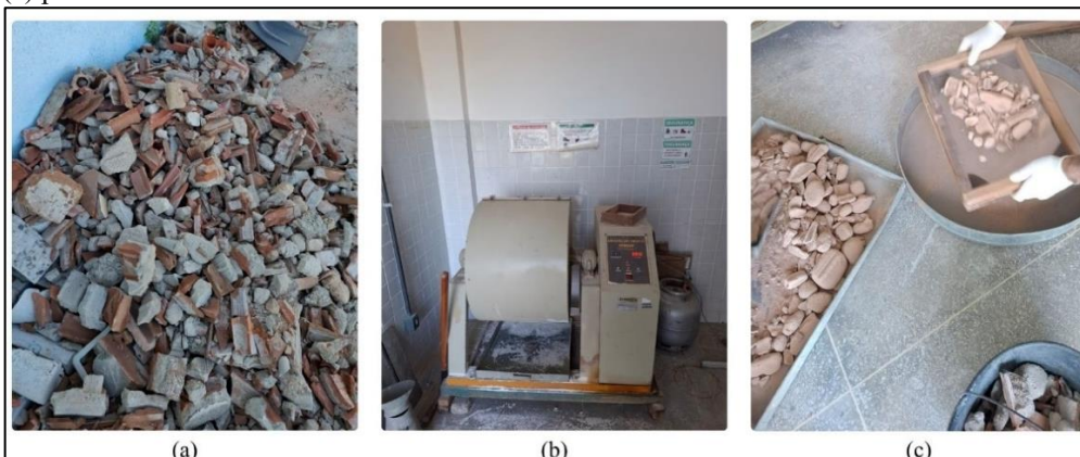
Figura 4 – Procedimentos da quebra do RCD: (a) quebra do RCD com a marreta; (b) abrasão; (c) peneiramento
