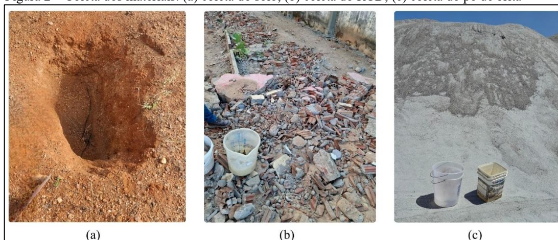
Figura 2 – Coleta dos materiais: (a) coleta do solo; (b) coleta do RCD; (c) coleta do pó de brita
