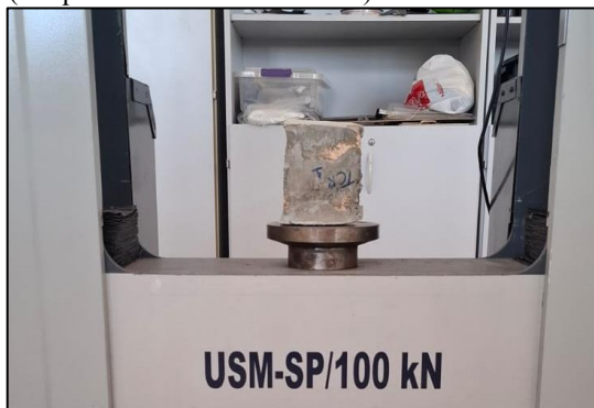
Figura 9 – Corpo de prova na prensa (máquina universal de ensaios)
