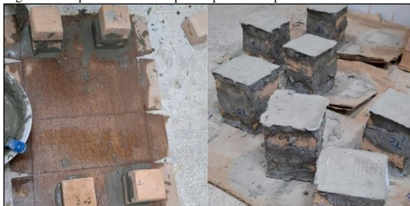
Figura 7 – Capeamento dos corpos de prova com pasta de cimento
