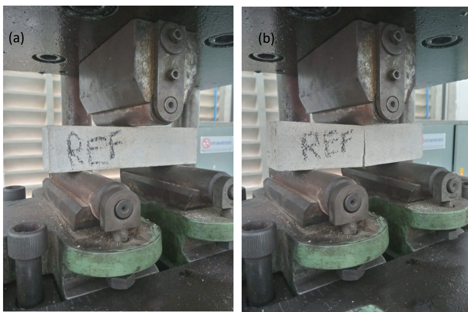
Figura 4 - Ensaio de resistência à tração na flexão.
