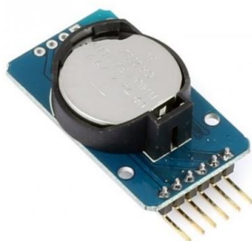
Figura 16. Relógio de Tempo Real, modelo RTC DS3231 (Autoria Própria)
