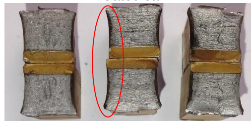
Figura 29 - Superfície de fratura dos corpos de prova do Aço A36 a 650 °C com Proteção Catódica
