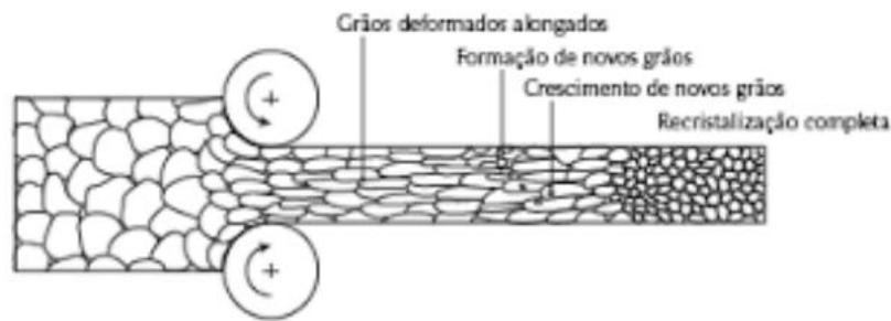
Figura 4 - Processo de laminação e recristalização.
