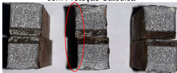
Figura 33 - Superfície de fratura dos corpos de prova do Aço F22 TRANSVERSAL a 650°C com Proteção Catódica
