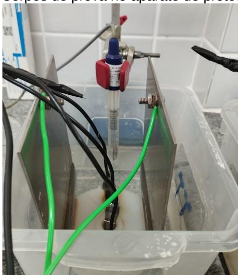
Figura 23 - Corpos de prova no aparato de proteção catódica.
