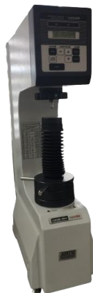
Figura 22 - Durômetro Mitutoyo HR – 320 MS.
