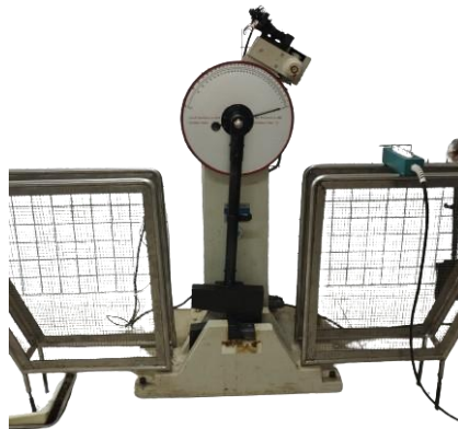
Figura 20 - Máquina de ensaio de impacto charpy modelo JB-W300A
