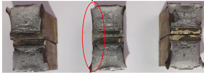
Figura 32 - Superfície de fratura dos corpos de prova do Aço F22 longitudinal a 677°C com Proteção Catódica
