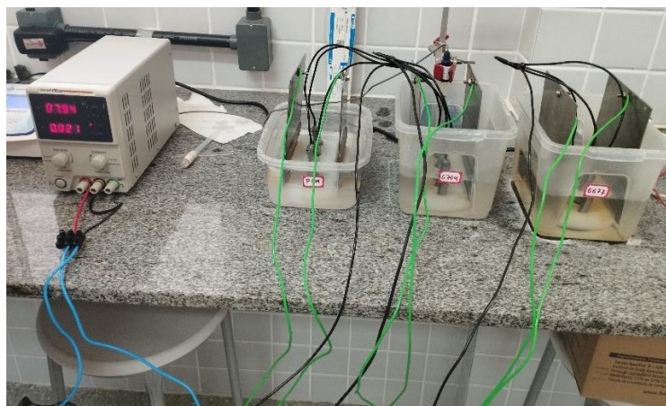
Figura 19 - Sistema montado para realização da proteção catódica
