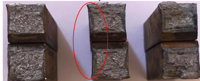
Figura 34 - Superfície de fratura dos corpos de prova do Aço F22 TRANSVERSAL a 677°C com Proteção Catódica
