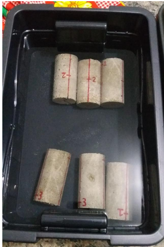
Figura 4 – Recipiente com os corpos de prova que foram submetidos ao ataque por sulfatos.
