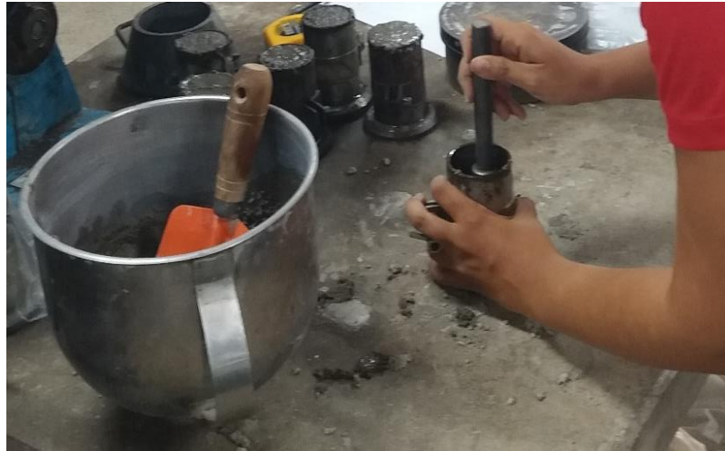
Figura 2 – Moldes cilíndricos de dimensões 50x100 mm.
