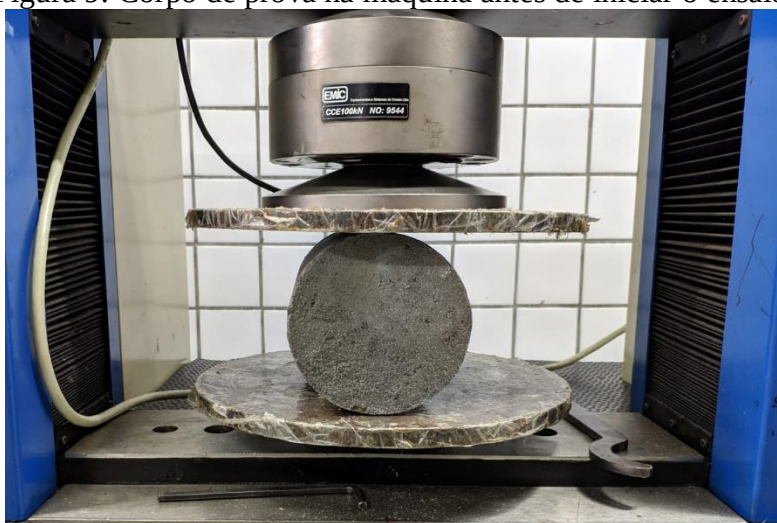
Figura 9: Corpo de prova na máquina antes de iniciar o ensaio.
