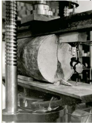
Figura 4: Brazilian Test - Ensaio de compressão diametral de um rolo de concreto, realizado pela Divisão de Materiais de Construção, década de 1940
