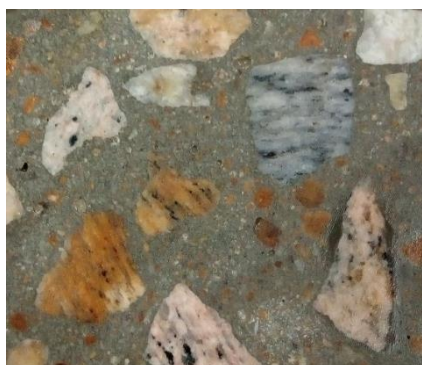
Figura 1 – Seção polida de um corpo de prova de concreto com areia natural
