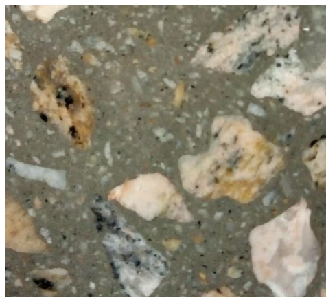
Figura 2 – Seção polida de um corpo de prova de concreto com pó de pedra
