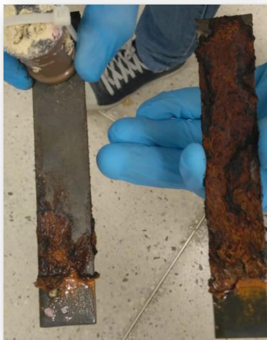
Figura 10: Comparativo do ataque corrosivo.
