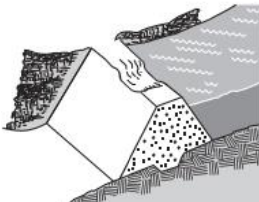
Figura 9 - Depressões na crista da barragem
