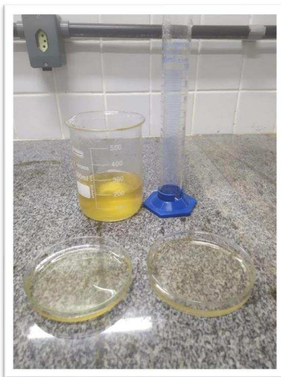
Figura 8 – Solução de quitosana despejada em placas de Petri.
