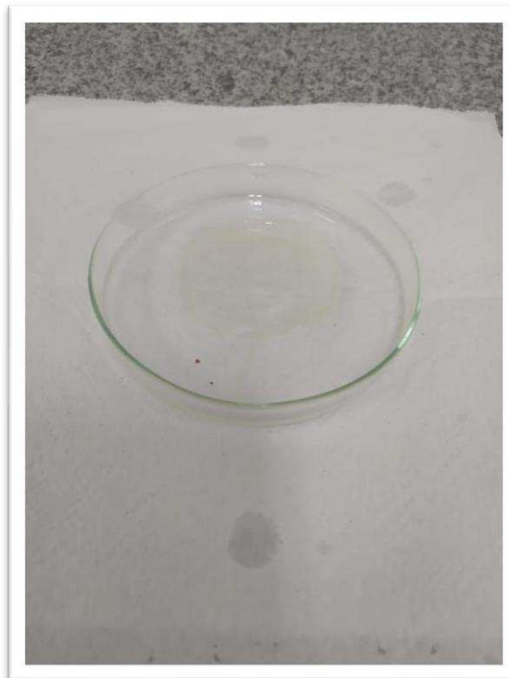
Figura 13 - Filmes lavados com água destilada e deixados em hidratação para evitar a degradação.
