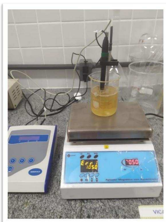
Figura 7 - Ajuste do pH da solução filmogênica.
