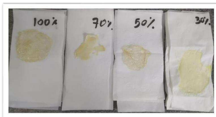
Figura 15 – Filmes em processo de secagem em temperatura ambiente.
