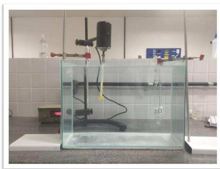
Figura 5 - Esquema de execução da técnica de viscosimetria capilar.
