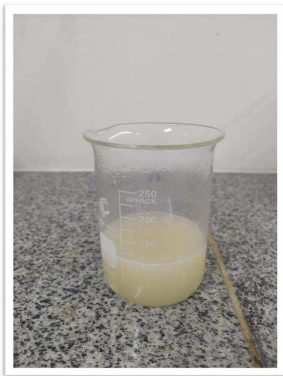
Figura 10 - Solução filmogênica 50 % de quitosana com adição de 50 % fécula de mandioca.
