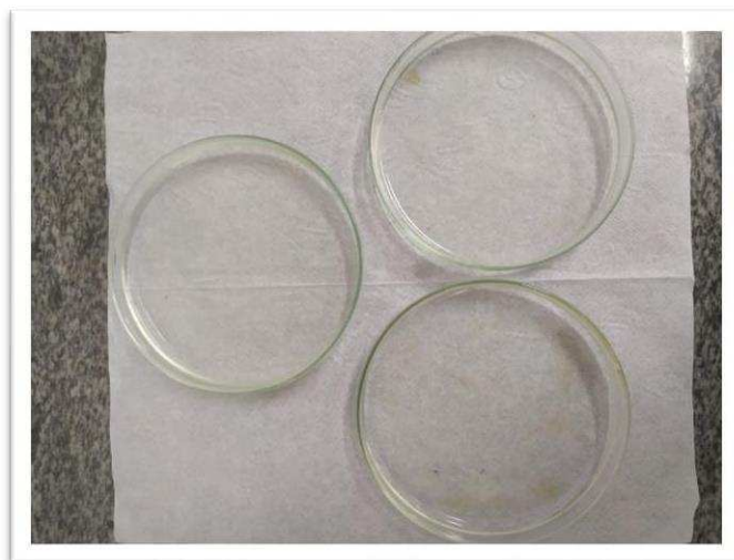
Figura 9 – Solução filmogênica de fécula, despejada em placas de Petri.
