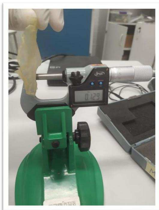
Figura 14 - Determinação da espessura dos filmes com o uso de um micrômetro digital.
