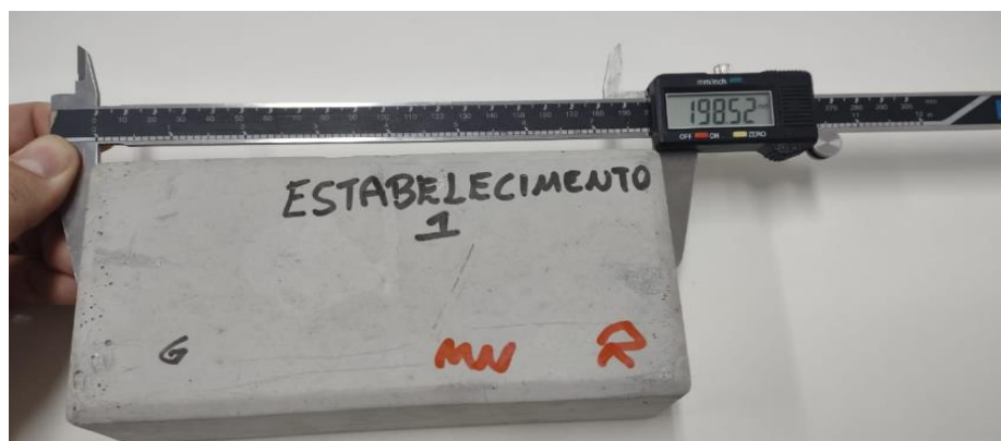
Figura 17 - Medição de dimensão da amostra.
