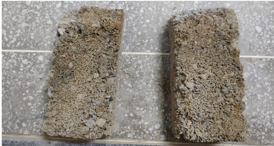
Figura 13 - Bloco com incorporação de 20% em massa de casca de arroz.
