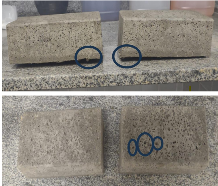
Figura 24 - Irregularidades nos blocos com casca de arroz.
