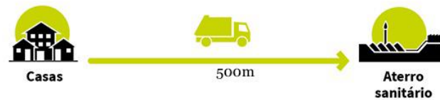
Figura 04: Distância mínima de aterros sanitários para residências.
