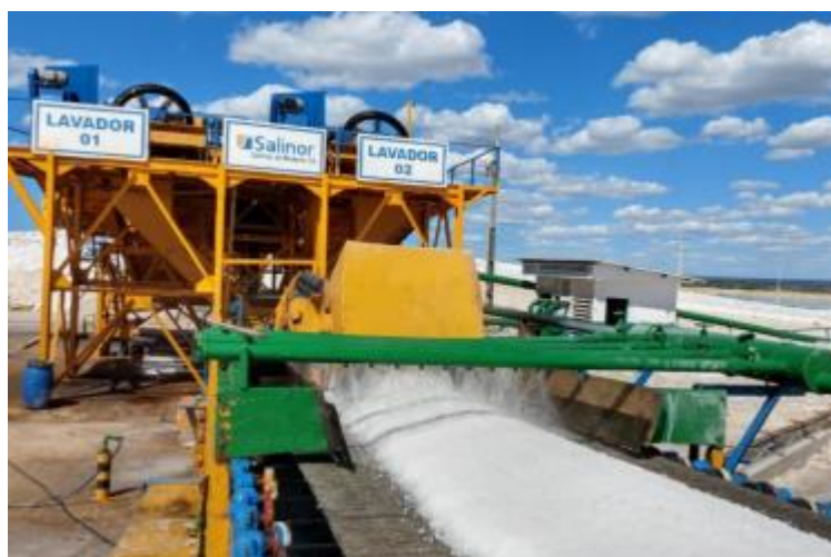
Figura 14 - Sal transportado na esteira de aço e sendo lavado pelos chuveiros.
