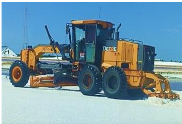
Figura 8 - Motoniveladora preparando o cristalizador para ser colhido.
