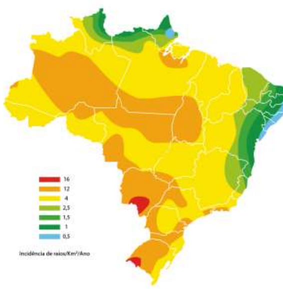
Figura 1 - Descargas Atmosféricas por Km 2 no Brasil.
