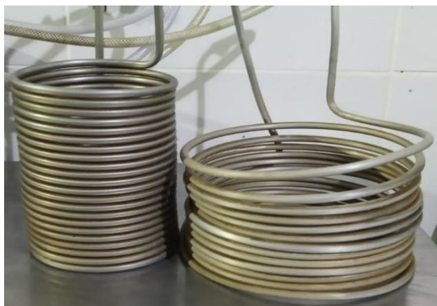
Figura 6 - Chillers de aço inox e alumínio utilizados na etapa de resfriamento do mosto
