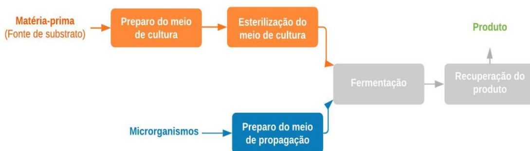
Figura 1 - Etapas do processo fermentativo (adaptado de Pinheiro, 2015)
