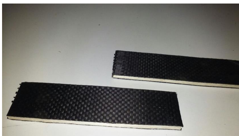
Figura 3- Compósito de fibra de carbono
