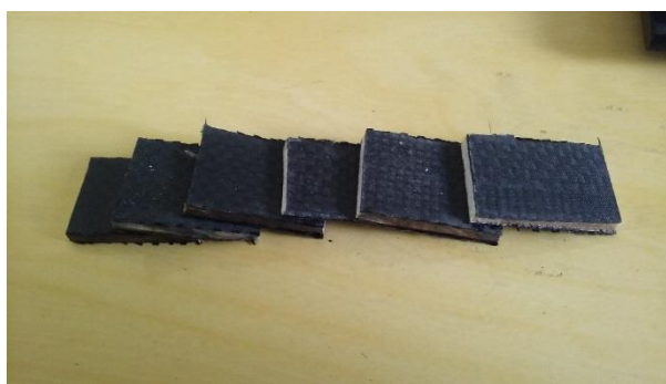
Figura 25- corpos de prova de fibras de carbono para ensaio de compressão
