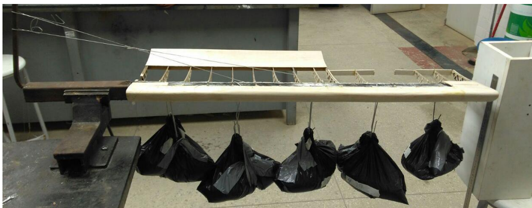
Figura 62- Sistema do ensaio estrutural
