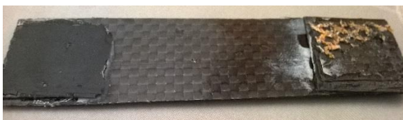
Figura 24- Corpo de prova de fibra de carbono laminada com resina epóxi
