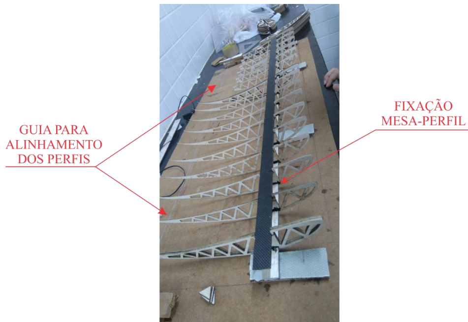
Figura 56- Fixação das mesas e almas nos perfis aerodinâmicos
