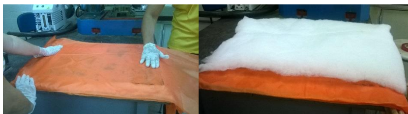
Figura 9- Processo de laminação à vácuo
