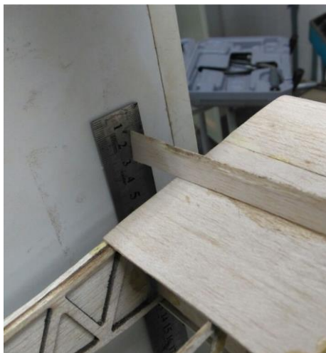
Figura 63- Deslocamento na ponta da asa
