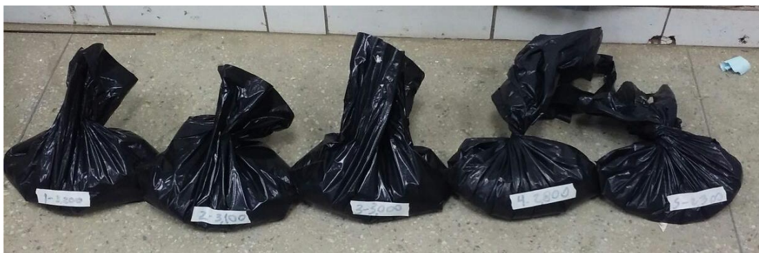
Figura 61- Cargas pontuais para ensaio estrutural
