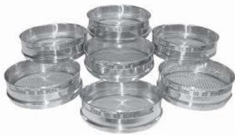
Figura 4 - Peneiras padronizadas da série Tyler ou da série americana.
