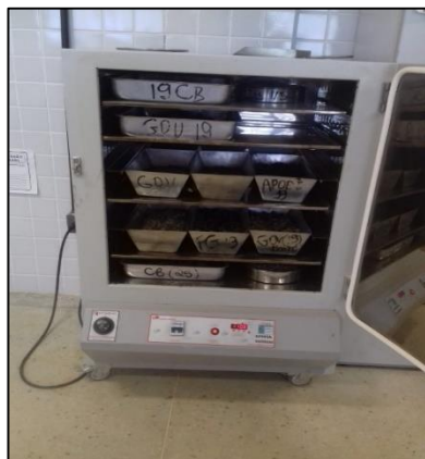
Figura 11 - Amostras de brita e cascalho na estufa para secagem.
