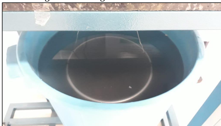
Figura 10 - Pesagem da brita submersa.
