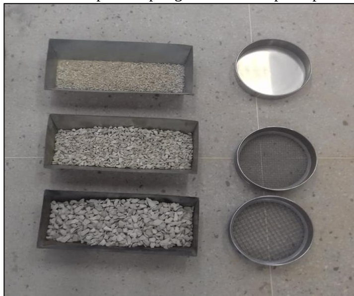
Figura 6 - Mostras separadas por granulometria após o peneiramento
