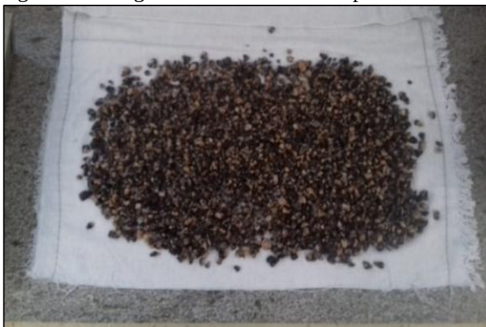
Figura 9 - Secagem do cascalho em um pano absorvente
