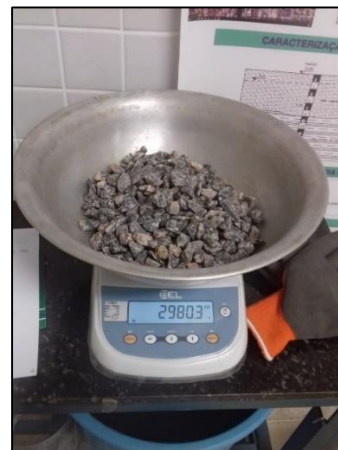
Figura 12 - Pesagem da brita seca.
