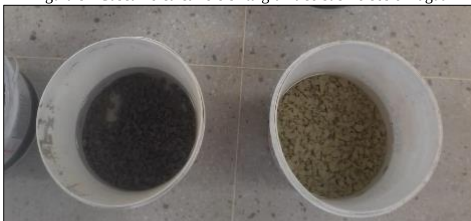
Figura 8 - Cascalho calcário e brita granítico submersos em água
