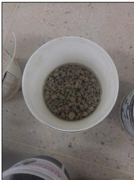
Figura 7 - Brita calcária submersa em água.
