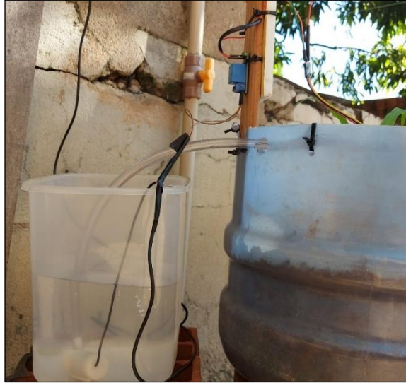
Figura 34 - Recipiente de 3 litros, responsável por fornecer água ao sistema.
