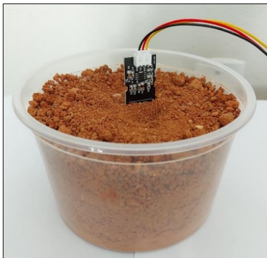
Figura 22 - Sensor de umidade inserido em um solo argiloso com umidade higroscópica.
