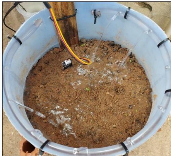
Figura 27 - Alguns pontos de aplicação da água com mais pressão que outros.
