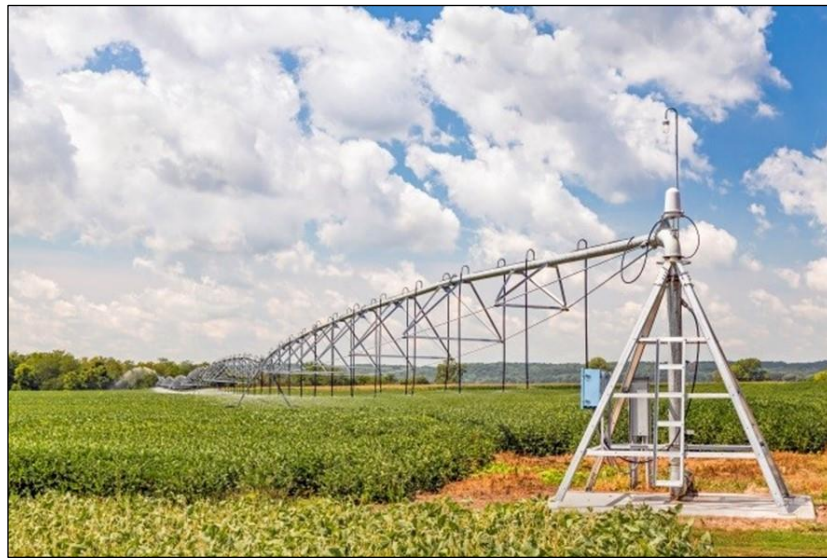
Figura 4 - Irrigação por Pivô Central.
