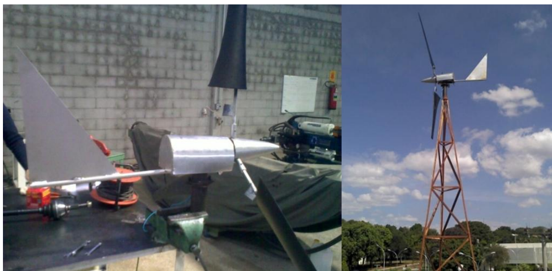
Figura 16: Aerogerador com pás de fibra de vidro
