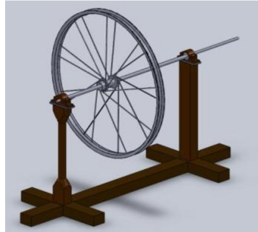
Figura 15: Representação da estrutura da turbina de eixo horizontal
