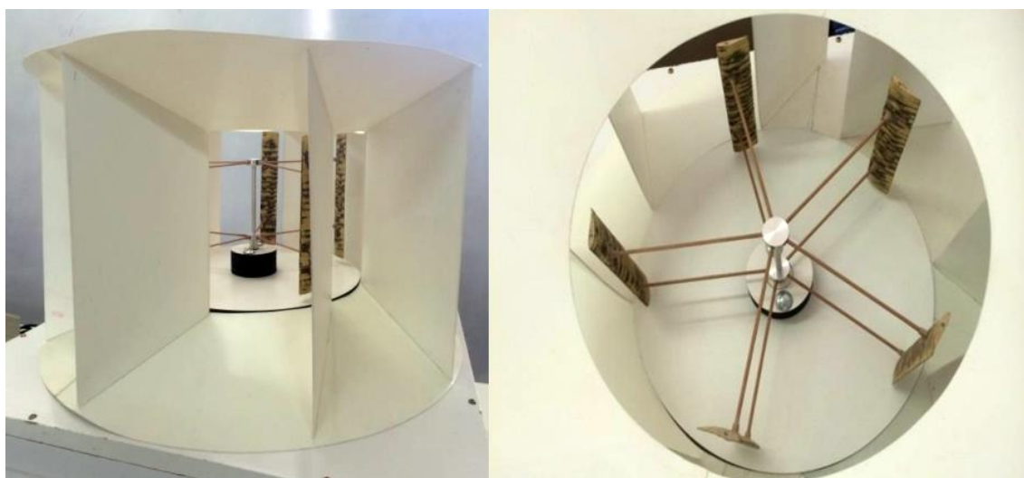
Figura 17: Túnel de vento e turbina H-Darrieus com 5 pás
