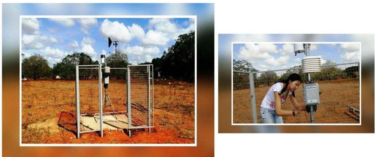
Figura 10. Estação Meteorológica automática do CETAPIS, instalada na Fazenda Experimental Rafael Fernandes.
