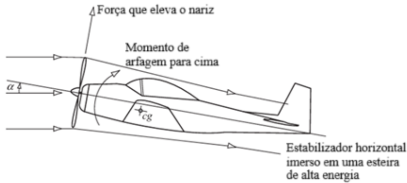
Figura 4. Efeitos típicos de fluxo induzido no momento de arfagem. (Adaptado de [5])
