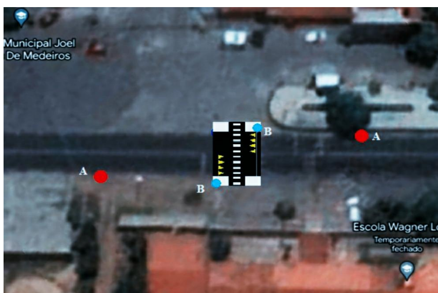
Figura 30 - Representação dos pontos de instalação de sinalização vertical no ponto 2
