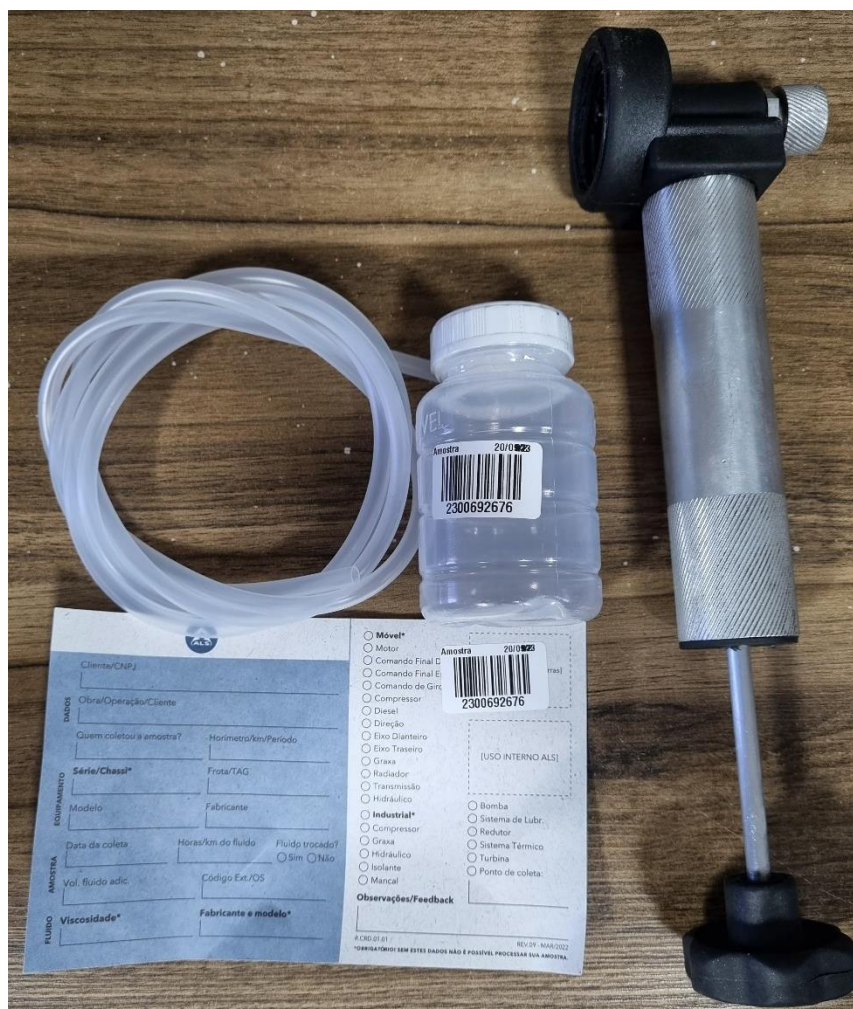
Figura 2 Kit de amostragem para coleta de óleo para análise. Fonte: autoria própria
