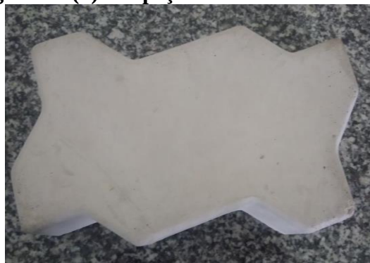
Figura 21 (b): Inspeção em bloco de 16 faces;
