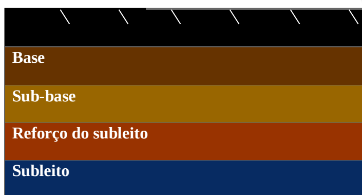
Figura 4: Composição do pavimento flexível
