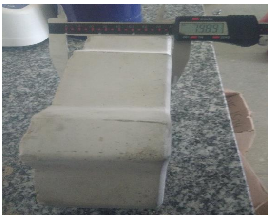
Figura 23 (a): Medição de espessura
