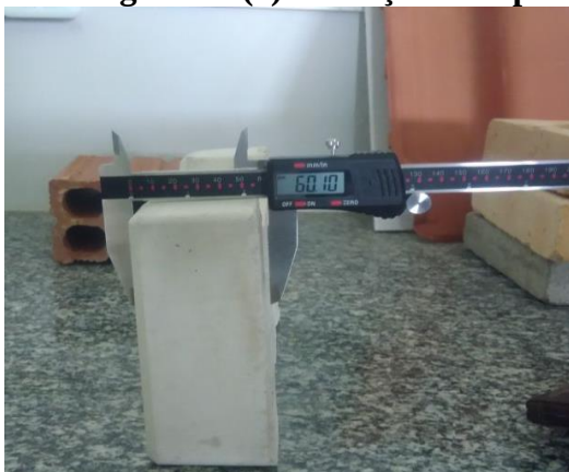
Figura 22 (a): Medição de espessura
