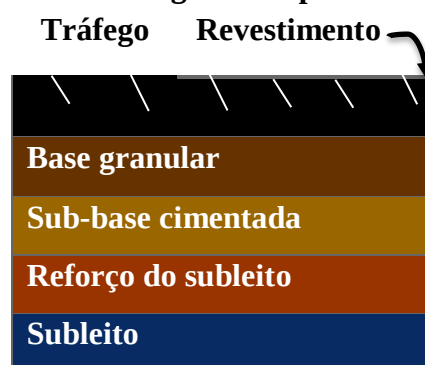
Figura 5 (b): Composição do pavimento semi-rígido do tipo indireto
