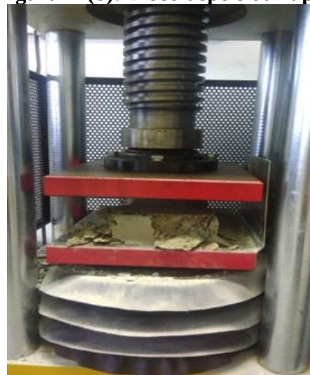
Figura 27(b): Bloco depois da ruptura
