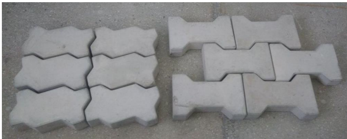
Figuras 21(c): Inspeção blocos intertravados.
