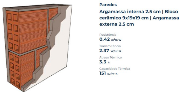
Figura 66 – Componentes construtivos - Parede
