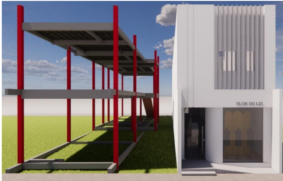
Figura 14: Arquitetura e estrutura ajustada
