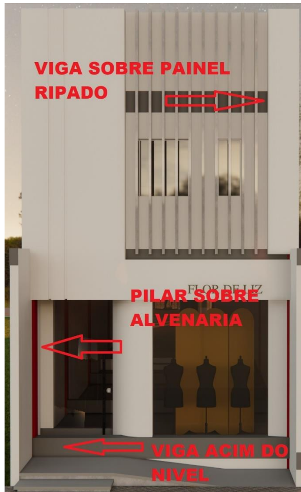
Figura 10: Fachada principal confronto de pilares e vigas sobrepondo a estrutura.
