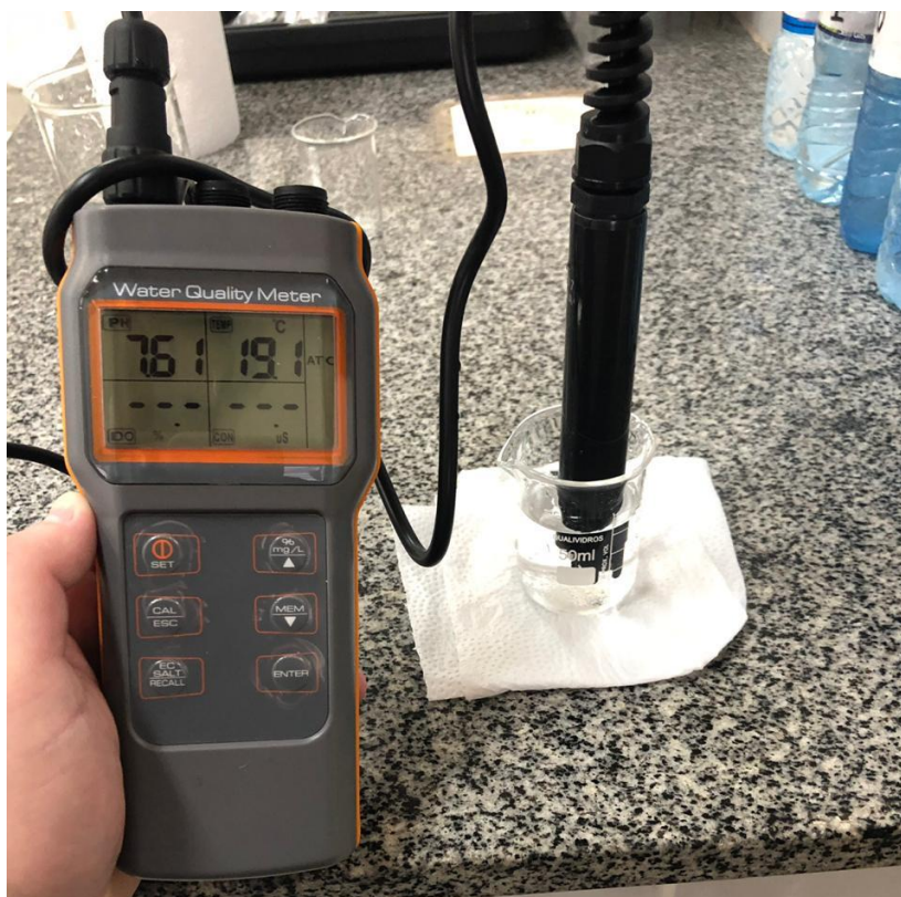
Figura 8 - Leitura de pH em uma amostra
