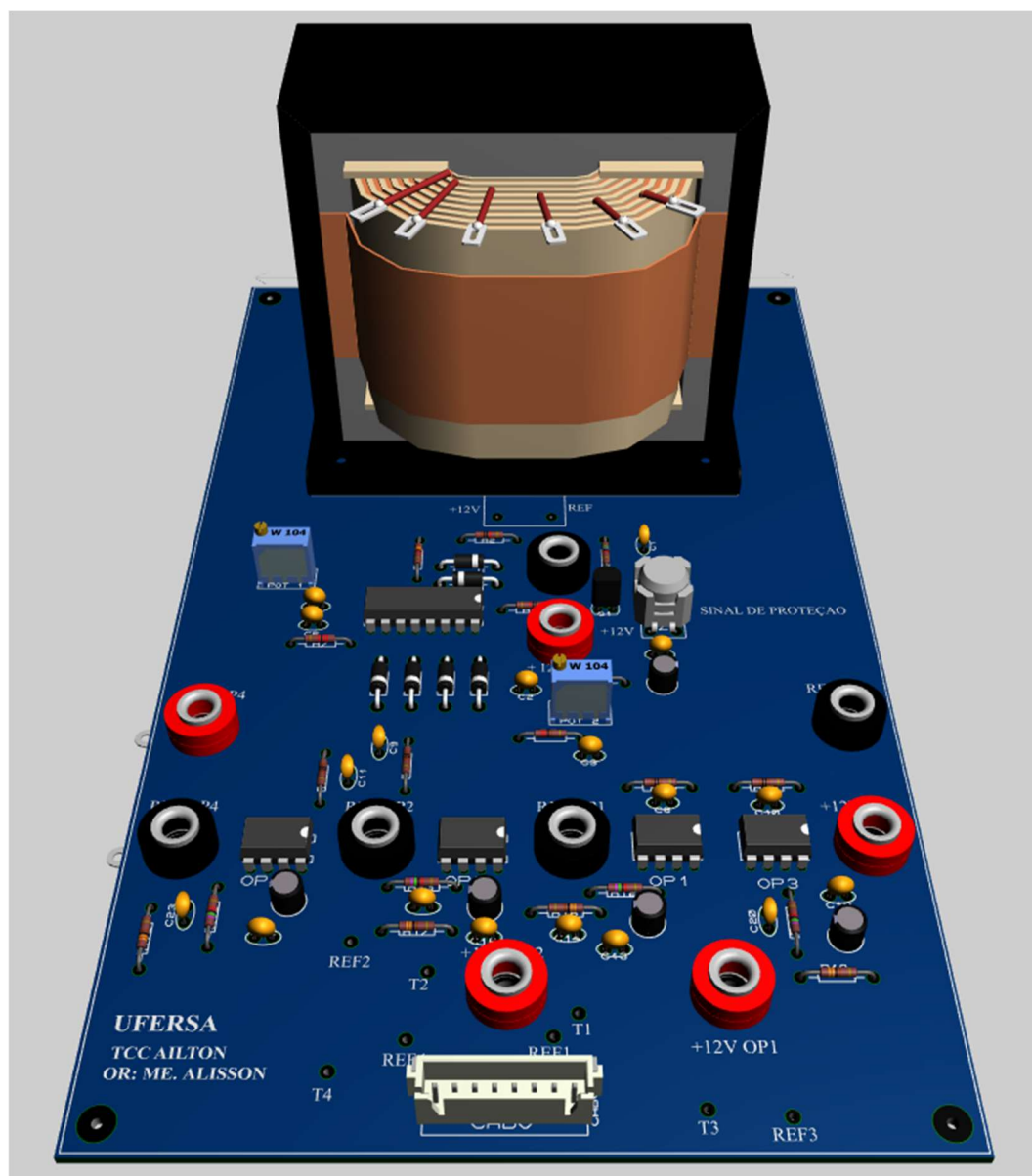
Figura 23 – Visão em 3D do circuito de comando na PCB.
