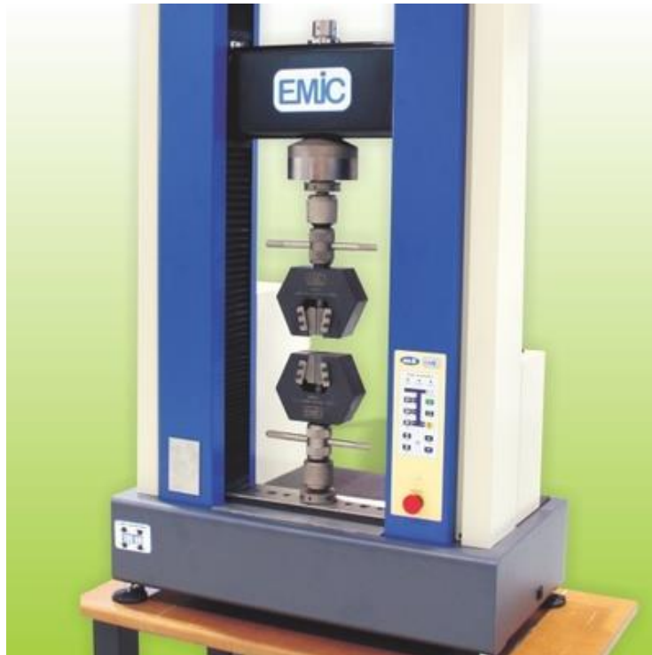
Figura 9 - Máquina EMIC para ensaio de tração
