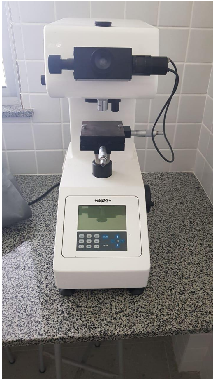
Figura 11 - Microdurômetro utilizado na microdureza Vickers
