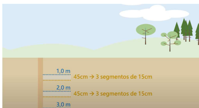
Figura 11 - Representação dos intervalos de execução do ensaio SPT.
